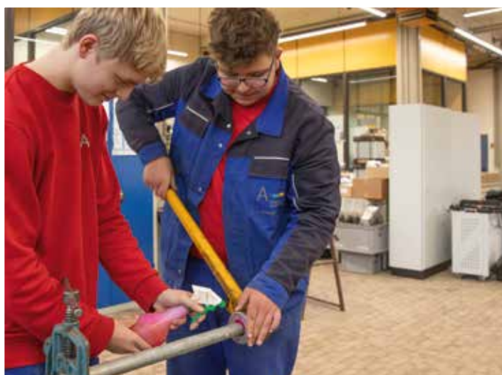
SCHON ZU BEGINN DER AUSBILDUNG KANN JUSTIN ZAHNER RICHTIG HAND ANLEGEN – HIER BEIM GEWINDESCHNEIDEN UND DEM ANSCHLIEßENDEN ANBRINGEN DES WINKELSTÜCKS MIT DER ROHRZANGE.
