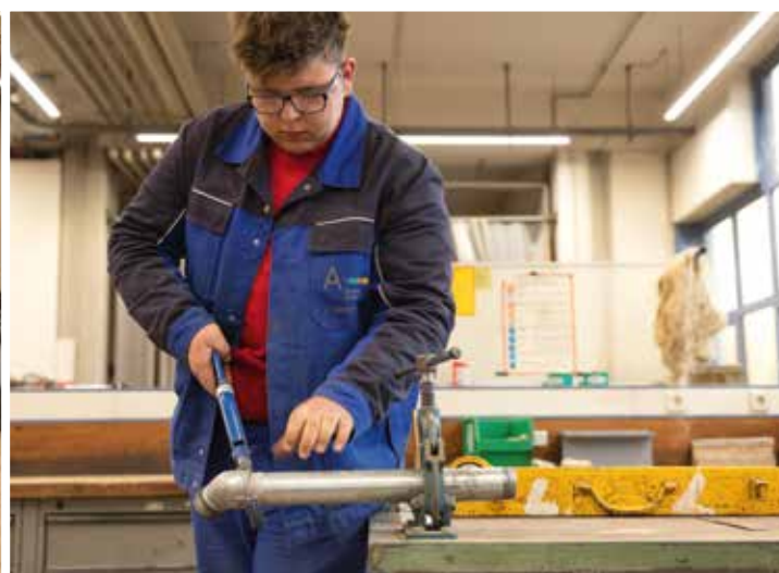
SCHON ZU BEGINN DER AUSBILDUNG KANN JUSTIN ZAHNER RICHTIG HAND ANLEGEN – HIER BEIM GEWINDESCHNEIDEN UND DEM ANSCHLIEßENDEN ANBRINGEN DES WINKELSTÜCKS MIT DER ROHRZANGE.
